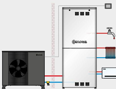
HYBRID SYSTEM WITH GAS CONDENSING BOILER
